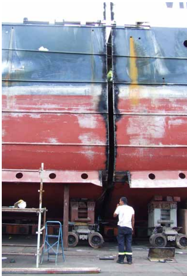
La découpe du navire s'est effectuée avec une tolérance presque nulle.
