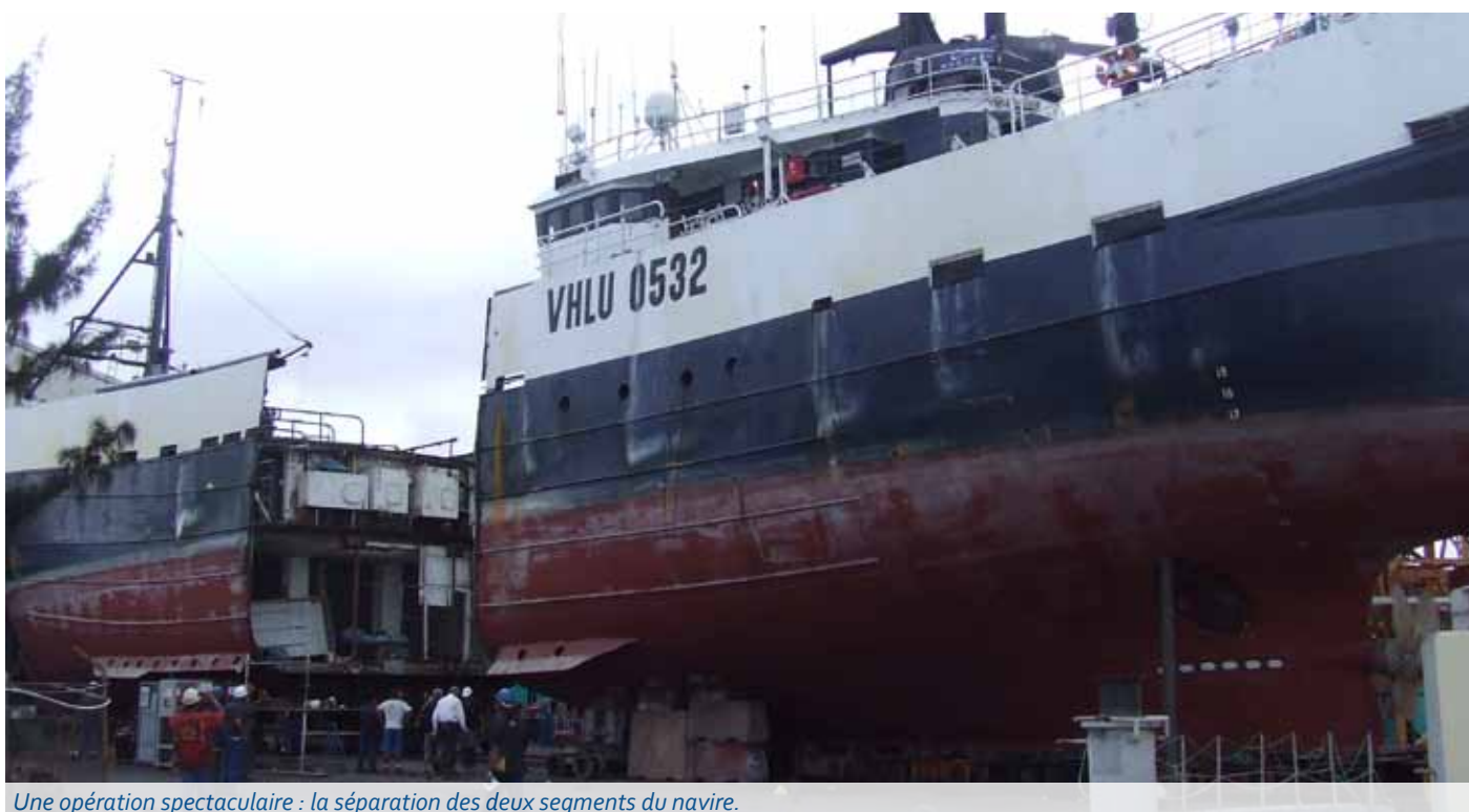
La découpe du navire s'est effectuée avec une tolérance presque nulle.
